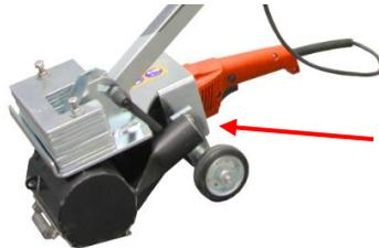
↖ Anschluss Staubsauger
